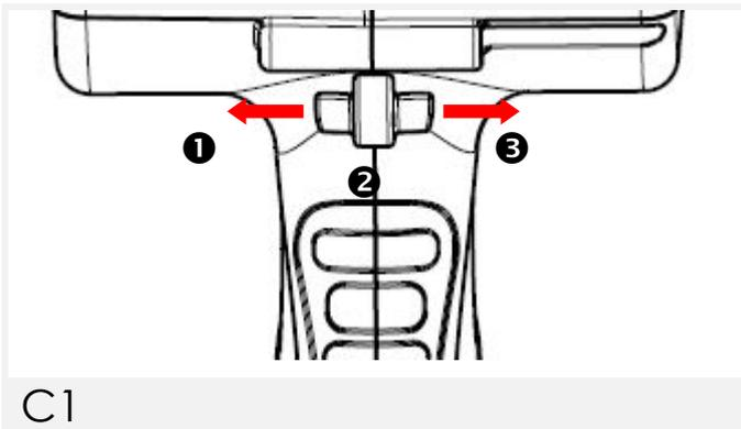
Die Umschaltung (3) steuert die Laufrichtung des Schneidmessers (2):
